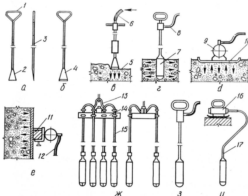
*а* - шуровка; *б* - ручная трамбовка; *в* - пневмотрамбовка; *г* - внутренний вибратор; *д* - наружный вибратор; *е* - наружный вибратор; *ж* - вибропакет; *з* - внутренний вибратор с двигателем в рабочем органе; *и* - вибратор с гибким валом;
