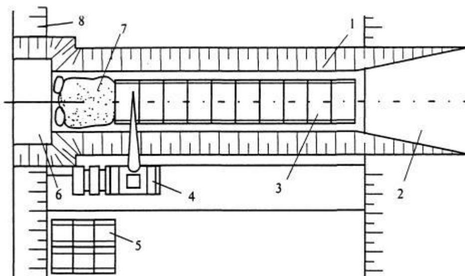
1 - котлован, отрытый в существующем уширенном земляном полотне; 2 - въезд в котлован в виде пандуса; 3 - уложенные лекальные блоки; 4 - автомобильный кран; 5 - склад лекальных блоков; 6 - котлован для оголовка; 7 - цементный раствор; 8 - откос насыпи
