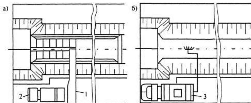
1 - бункер с металлическим рукавом, подающим цементобетонную смесь для заполнения пазух; 2 - автомобиль-самосвал, доставляющий бетонную смесь; 3 - автогудронатор с ручным распределителем битума для гидроизоляции
