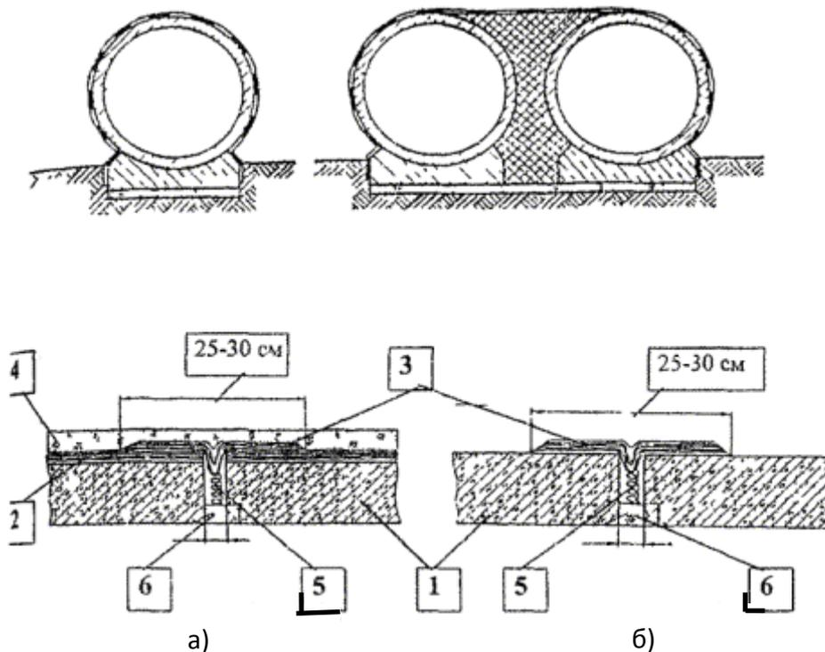
устройство гидроизоляции над деформационными межсекционными швами труб на фундаменте при битумной мастичной армированной гидроизоляции типа БМ-1;
