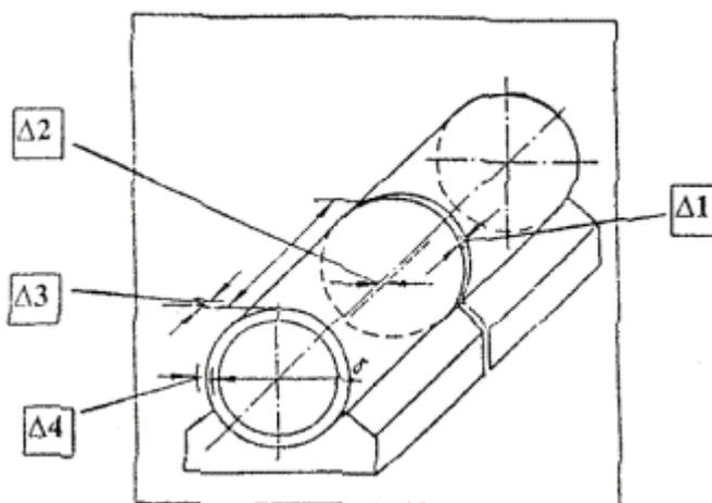
Рисунок К.2 - Круглая железобетонная труба на фундаменте из леечных блоков
